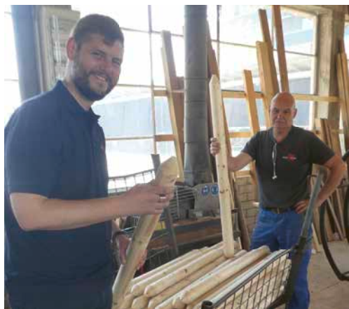
Hier zeigte Pepe Wyss Holzpfähle als Halbfertigprodukte nach dem Zuschchnitt auf die gewünschte Höhe und dem Zuspitzen.
