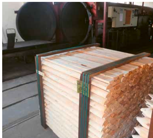
Die Fertigprodukte sind als Rohlinge bereit für die Druckimprägnierung.
