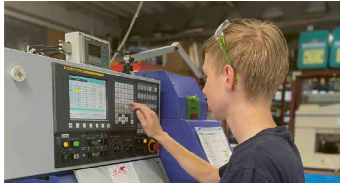
Korrigieren eines Teildurchmessers im Offset der Maschine. Bild: zvg
